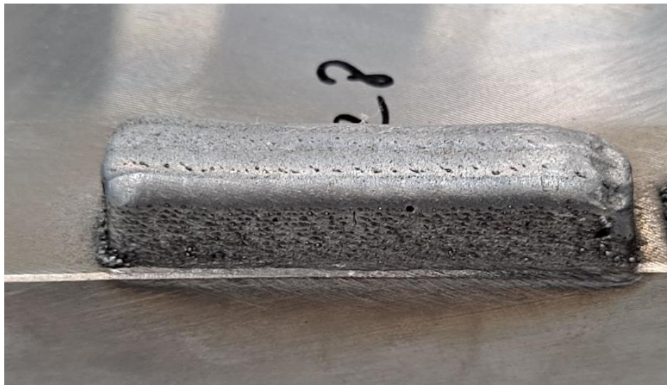
Detalle de los recubrimientos solapados uno encima del otro para desarrollar crecimiento de capa de hasta 10mm.
